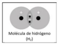
Las atracciones unen a los dos átomos de hidrógeno y ambos átomos comparten los electrones, logrando un enlace covalente.
