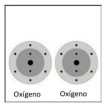
Cada átomo de oxígeno tiene 6 electrones en su nivel externo de energía.
