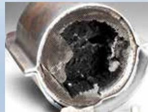
La pantalla dentro de un convertidor catalítico está recubierta de platino. ¡Ese es el catalizador!
