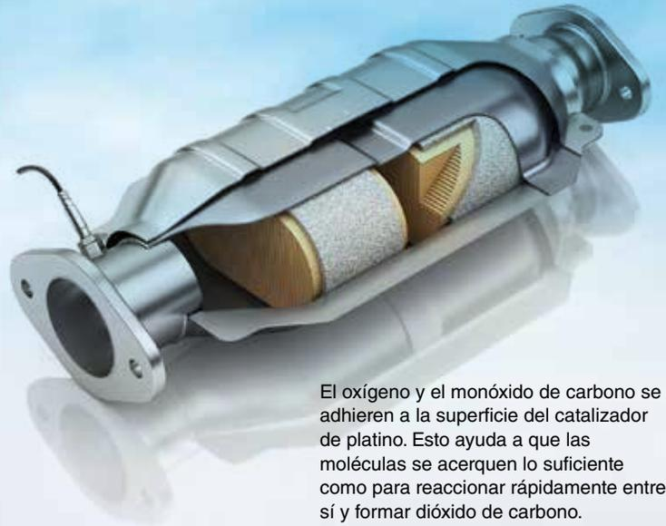
El oxígeno y el monóxido de carbono se adhieren a la superficie del catalizador de platino. Esto ayuda a que las moléculas se acerquen lo suficiente como para reaccionar rápidamente entre sí y formar dióxido de carbono.
